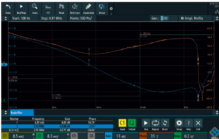
直流/直流变换器的稳定性测量（蓝色迹线，增益；橘色迹线，相位；绿色迹线，激励信号的幅度分布）。
